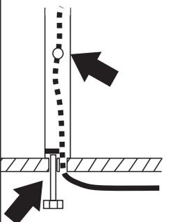
A coluna deverá ser posicionada com o interruptor de frente para a bancada a ser iluminada, assim a lâmpada ficará posicionada no sentido longitudinal.
