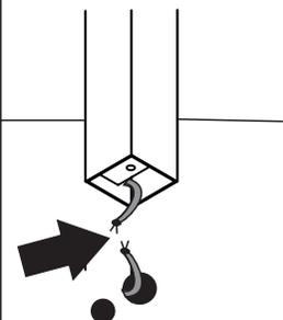
Ligue os cabos da coluna na rede elétrica e isole-os com fita anti-chamas
